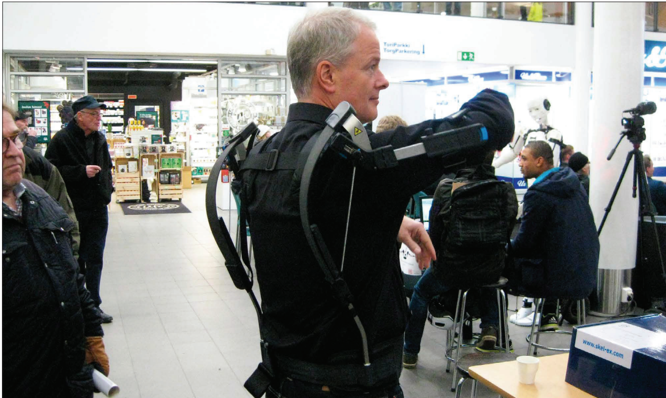
Yläraajakevennin on passiivinen robotti, joka vähentää kuormittavien työasentojen aiheuttamaa rasitusta. Pekka Laine esitteli laitetta Rewell Centerissä. KUVA: MIIKA HUHTA
