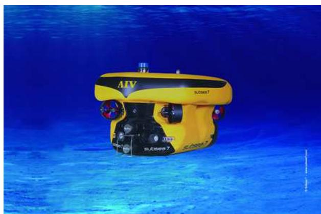
El vehículo de inspección autónoma (AIV) Subsea 7 (Foto: Heriot-Watt University)
